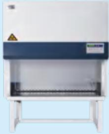
• La cabine de sécurité biologique est conçue pour protéger l'opérateur, l'environnement de laboratoire et les échantillons contre l'exposition aux aérosols infectieux produits lorsque l'échantillon est constitué de souches bactériennes, de matériel de diagnostic et d'autres sujets infectieux.
